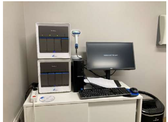
Photo du GeneXpert : machine de biologie délocalisée fournissant des résultats de PCR (Polymerase Chain Reaction, séquençage de matériel génétique) en 1 à 2 h
